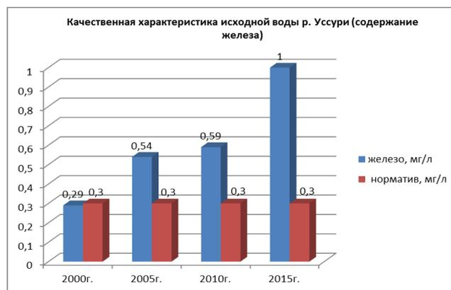
Рисунок 3. Качественная характеристика исходной воды реки Усури (содержание железа)
