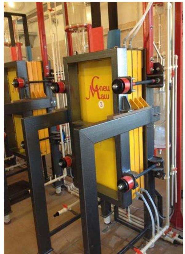
Рис.2 Внешний вид мембранного электролизера
